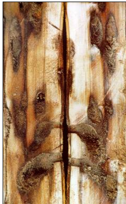
Der selbe Stamm aufgeschnitten, deutlich sind die Fraßgänge und die angelegten Puppenwiegen zu erkennen. Der Gang vor der Puppenwiege wurde vor dem Schlupf mit groben Holzspänen verstopft (Holzgenagel).
